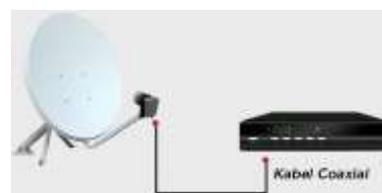
Gambar 17. Instalasi Kabel *Coaxial* antara LNB dan *Receiver*.
