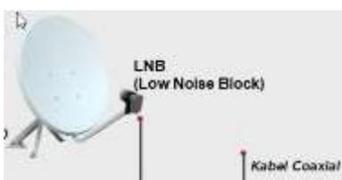
Gambar 14. Instalasi LNB pada bracket Dish parabola
