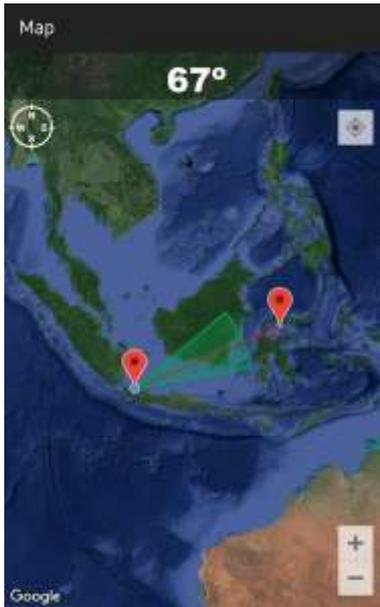
**Gambar 3.** Sudut Azimuth 67° dari BBPLK Bekasi ke arah Satelit AsiaSat-9
