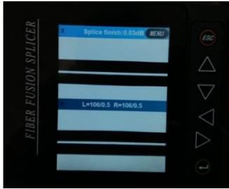
Gambar 11. Melakukan Fusion Splicing antara Pigtail dengan Core dari ODC
