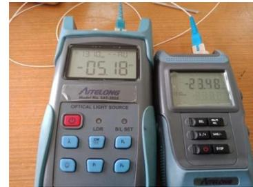
**Gambar 20. Hasil Pengukuran Menggunakan OLS dan OPM.**
