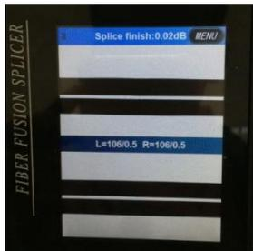
Gambar 12. Melakukan Fusion Splicing antara Pigtail dengan Core dari ODC
