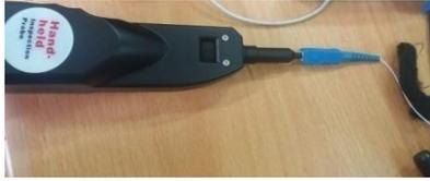
**Gambar 16. Pemasangan Konektor Pada Hand-Held Inspection Probe**
