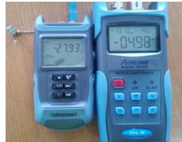
Gambar 15. Hasil Pengukuran pada OLS dan OPM
