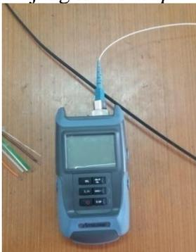
Gambar 13. Melakukan Pemasangan OPM
