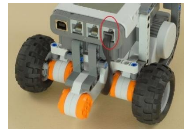
Gambar 8. Pemasangan Kabel dari Port Motor ke Port NXT
