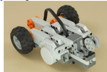
Gambar 6. Pemasangan Free Wheel pada Bagian Belakang Robot
