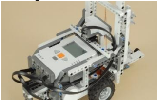
Gambar 12. Pemasangan Sensor Ultrasonic
