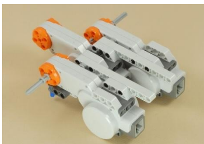
Gambar 4. Pemasangan Motor Servo
