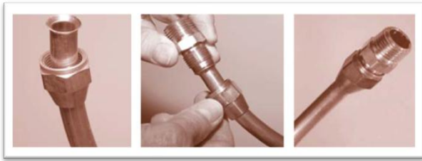
Gambar 21. (a) Ujung pipa yang di-flare 45° (b) Proses pemasangan flare joint (c)Sambungan flare lengkap
