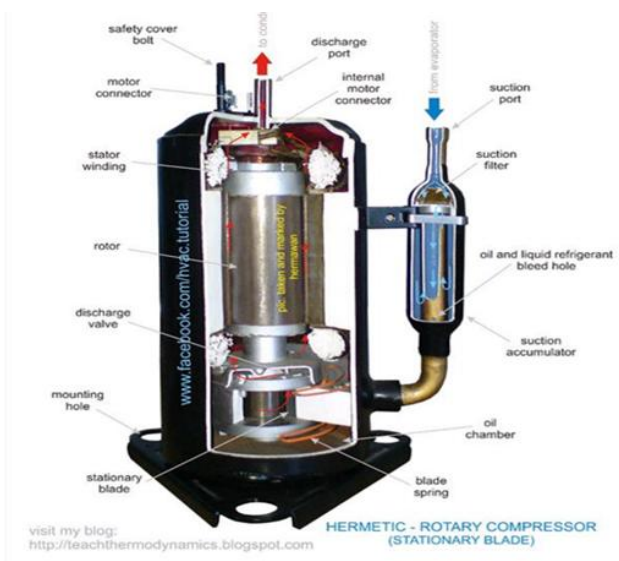
Gambar 2. Skemapotongan Kompresor 1 Fasa
