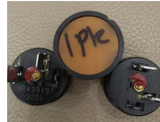
Gambar 12. Overload pada AC
