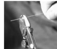
Gambar 7. Pengupasan *Coating* dan *Cladding*
