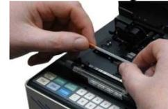
Gambar 6. Pemasangan *Protection Sleeve*
