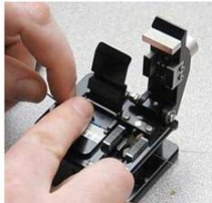
Gambar 9. Meratakan Ujung Core dengan Fiber Cleaver
