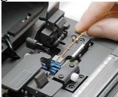
Gambar 10. Meletakkan core pada alur V
