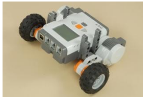
Gambar 14. Pemasangan Motor Servo pada NXT
