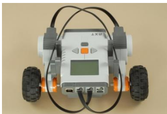
Gambar 16. Pemasangan Kabel pada Port Motor NXT
