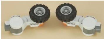
Gambar 12. Pemasangan Roda pada Motor Servo
